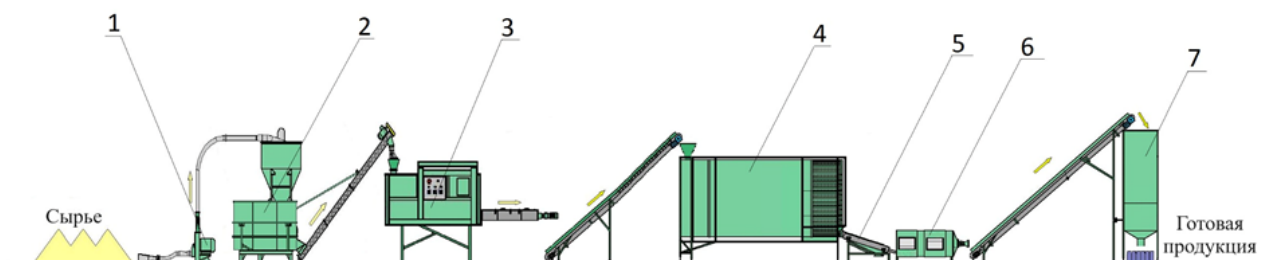
Рисунок 1. Технологическая схема производства кормов для служебных собак методом экструдирования. 1 – пневматическая дробилка; 2 – смеситель-увлажнитель; 3 – экструдер; 4 – сушильная камера; 5 – рассеиватель-охладитель; 6 – дражировщик; 7 – бункер готовой продукции.
