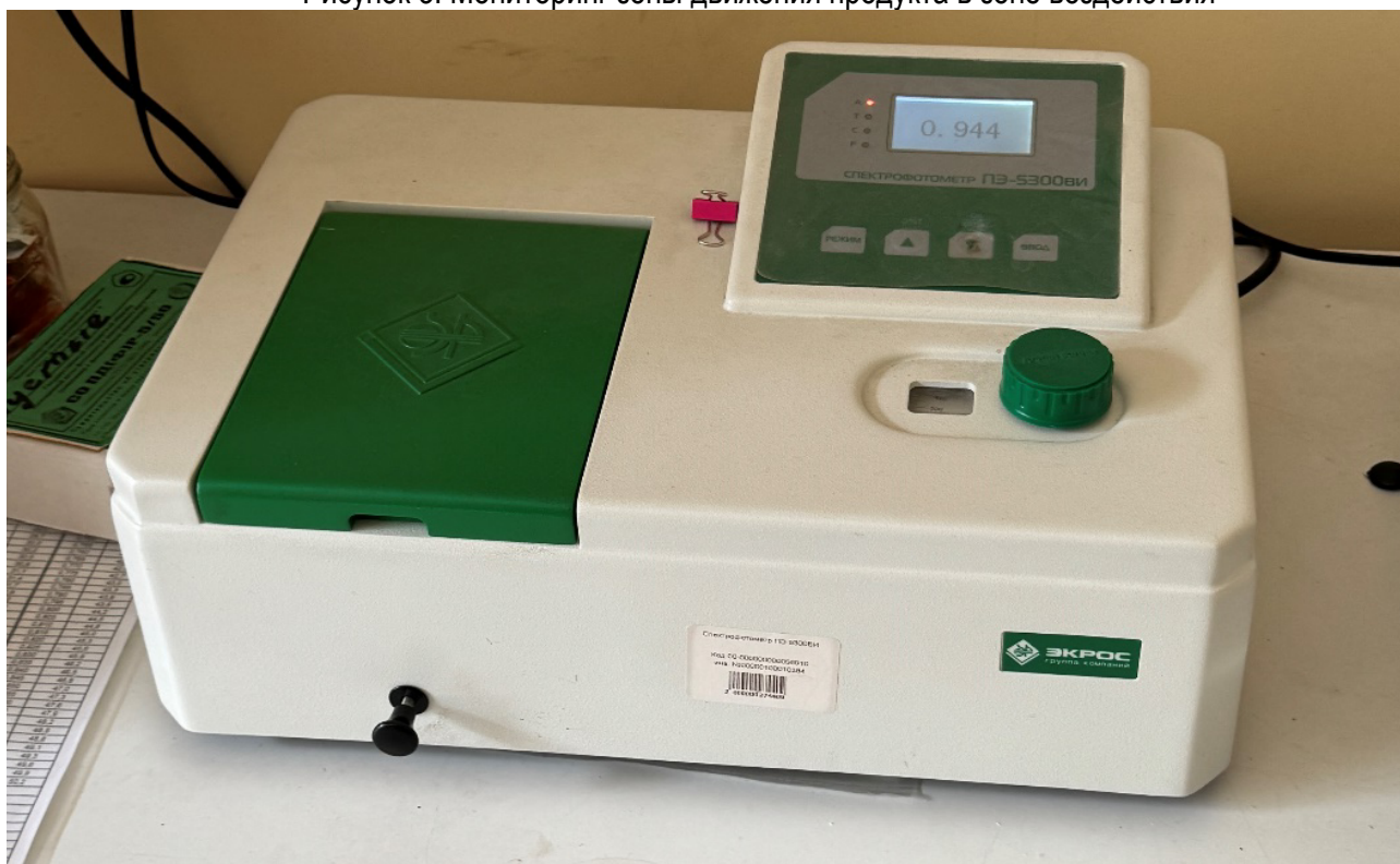
Рисунок 4. Спектрофотометр для контроля дозы облучения в продукте
